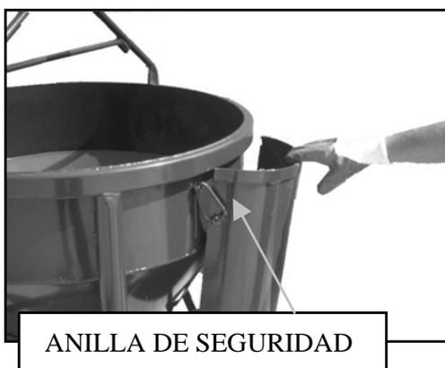
La figura muestra la teja replegada con la anilla de seguridad actuando. Para efectuar el despliegue completo el cubilote debe estar suspendido de un aparato de elevación.
