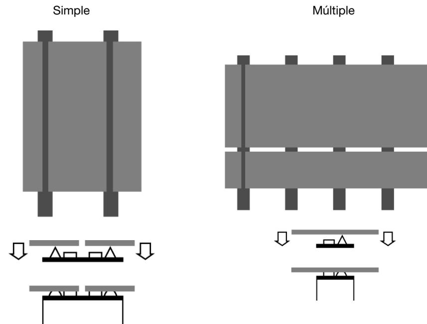
Anchura requerida de los rastreles de la subestructura para la utilización del sistema SikaTack® Panel:
