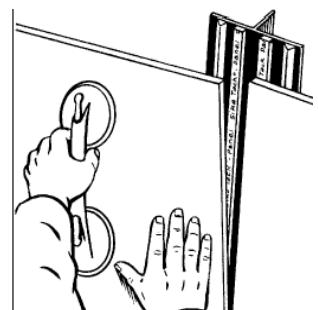
**Nota Importante:** El emplazamiento del panel debe completarse antes de que pasen 10 minutos después de la aplicación del adhesivo a los rastreles de la subestructura.
