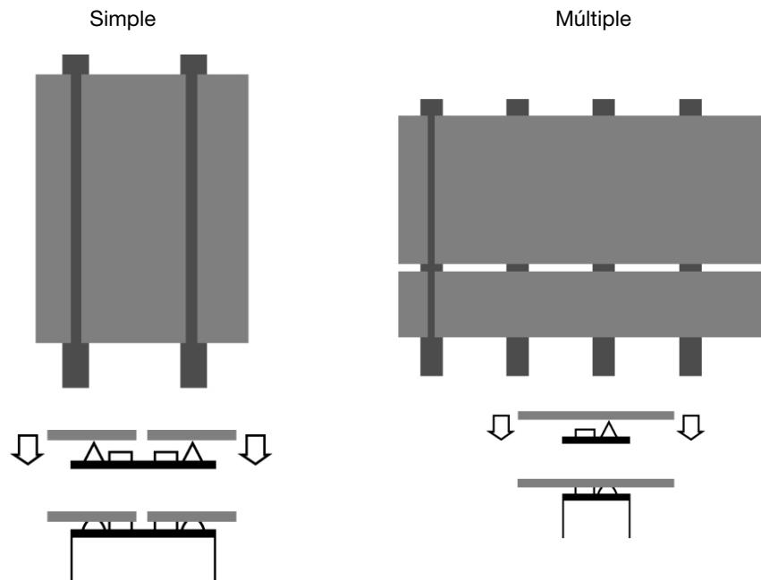
Anchura requerida de los rastreles de la subestructura para la utilización del sistema SikaTack® Panel:
