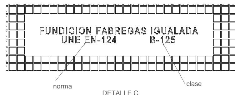
Material: Fundicion ductil GGG-40
