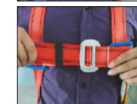
3. Tire del extremo sobrante de las cintas para ajustar el arnés. Deslice las hebillas hasta la posición correcta y pliegue y sujeté los excesos de cinta con el retenedor elástico.
