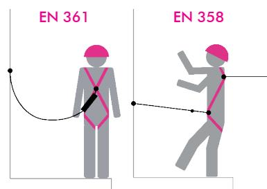
El arnés A50B cumple con la norma EN 361 de dispositivos anticaídas (puntos de anclaje dorsal y pectoral) y con la norma EN 358 de dispositivos con cinturones de posicionamiento.
