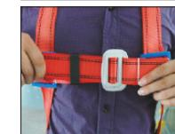
3. Tire del extremo sobrante de las cintas para ajustar el arnés. Deslice las hebillas hasta la posición correcta y pliegue y sujeté los excesos de cinta con el retenedor elástico.
