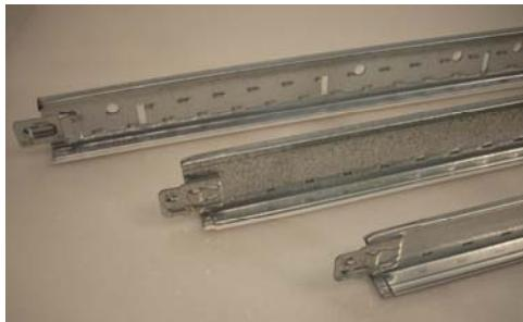
El ancho de los perfiles es de 24 mm y altura de 32 mm para primarios y secundarios de 1.2 m mientras que el secundario de 0.6 m tiene una altura de 25 mm. El conjunto conforma una cuadrícula de 600x600 mm diseñada para la colocación de placas aislantes de diferentes tipos.
